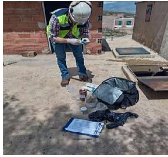
TOMA DE MUESTRA DE AGUA DE CONSUMO (AG-01) AOP PARA LA ELABORACIÓN DE DEL IMA DE LA AOP “CIERRE TÉCNICO CLAUSURA Y SANEAMIENTO AMBIENTAL DEL BOTADERO MUNICIPAL DE COLCAPIRHUA”.
